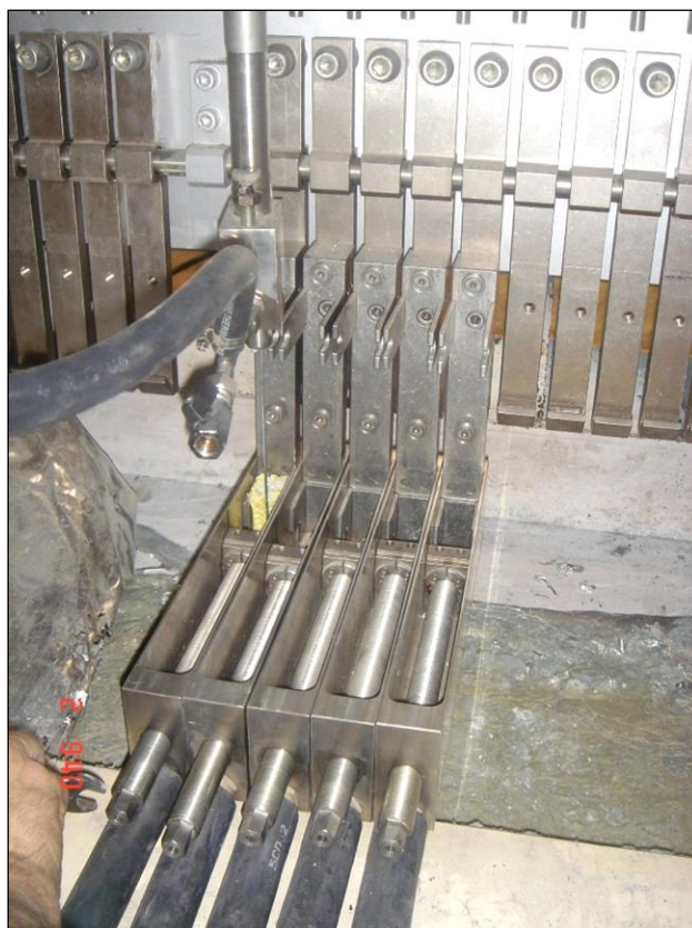
Figura 4: Equipamento de secagem de zinco em arames galvanizados a quente [12].
